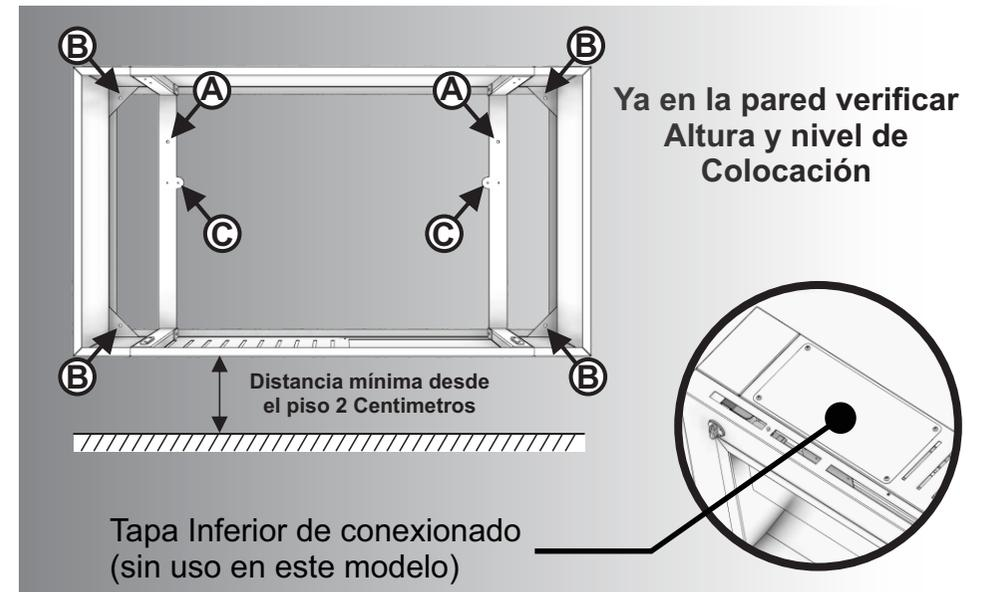
sujetar la funda con tarugos / tornillos en **A** y **B**
